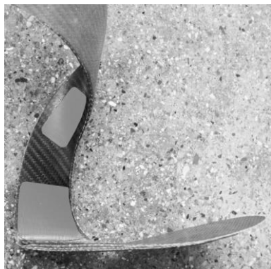
Figura 6: Applicazione dei velcri sul montante
